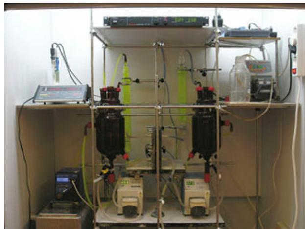
**Figura 2.** Planta escala bancada de una planta de electrosíntesis de oxidantes. Producción de hidrógeno como subproducto
