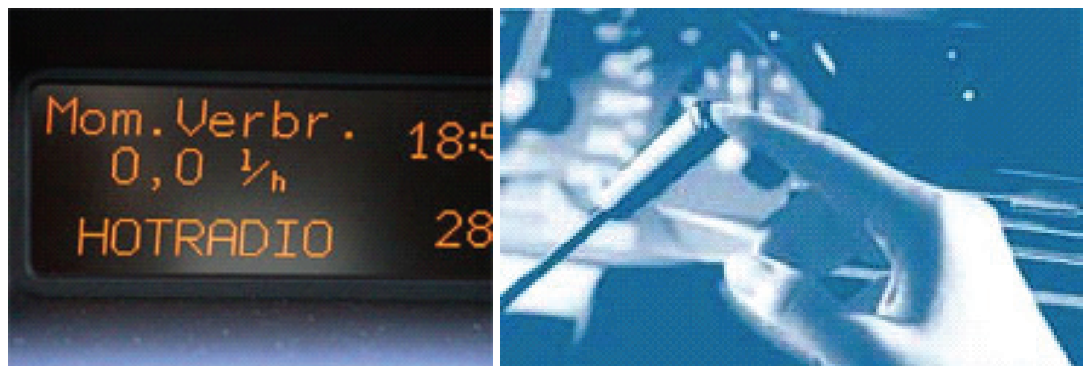
Algunos dispositivos de ahorro de combustible dentro del propio coche: ordenador de a bordo y control de crucero
