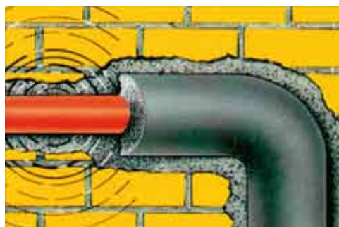
Figura 19: Reducción acústica en una tubería aislada
