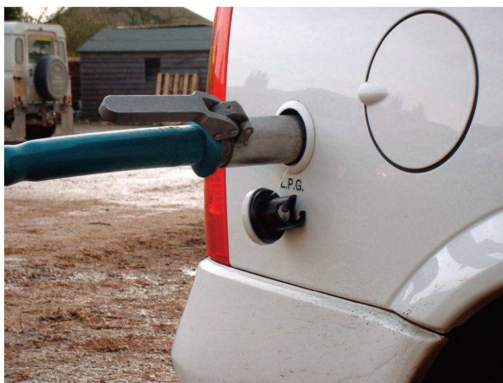
Repostaje de GLP
