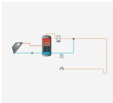
Sistema solar térmico para la producción de agua caliente sanitaria (ACS) en instalaciones de consumo único con acumulador solar, intercambiador interno, sistema de apoyo conectado en serie y válvula termostática.
