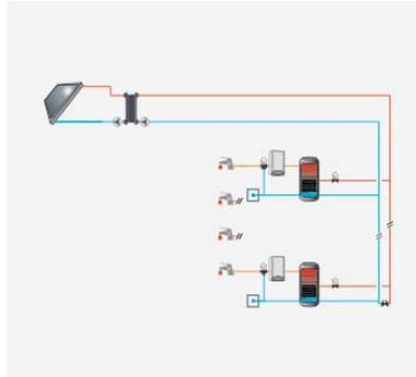
Sistema solar térmico para la producción de agua caliente sanitaria (ACS) en instalaciones de consumo múltiple con acumuladores individuales, intercambiador de calor interno, sistemas de apoyo instantáneos en serie y válvulas termostáticas.
