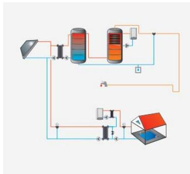
Sistema solar térmico para la producción de agua caliente sanitaria (ACS) y el calentamiento de una piscina cubierta con intercambiadores de calor externos para ACS y piscina, acumulador solar y de apoyo centralizados, sistema de apoyo conectado con intercambiador interno o resistencia eléctrica y válvula termostática.
