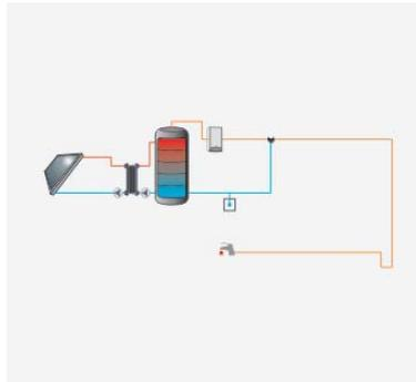
Sistema solar térmico para la producción de agua caliente sanitaria (ACS) en instalaciones de consumo único con acumulador solar, intercambiador externo, sistema de apoyo conectado en serie y válvula termostática.
