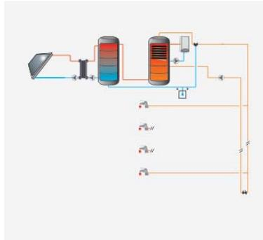
Sistema solar térmico para la producción de agua caliente sanitaria (ACS) en instalaciones de consumo múltiple con acumulación solar centralizada, intercambiador de calor externo, acumulación de apoyo centralizada, sistema de apoyo conectado con intercambiador interno o resistencia eléctrica y conexión directa del circuito de distribución.
