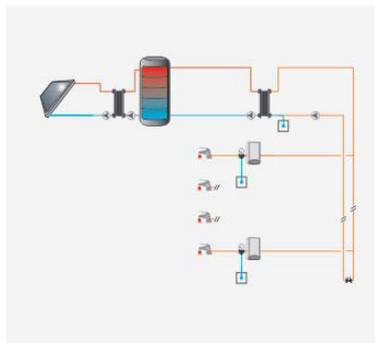
Sistema solar térmico para la producción de agua caliente sanitaria (ACS) en instalaciones de consumo múltiple con acumulación solar centralizada e intercambiador de calor externo, intercambiador de calor centralizado para la preparación de ACS, sistemas de apoyo instantáneos en serie y válvulas termostáticas.
