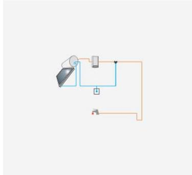
Sistema solar térmico prefabricado para la producción de agua caliente sanitaria (ACS) en instalaciones de consumo único con válvula termostática. *En este tipo de instalaciones, es posible definir un sistema apoyo tipo “Termo eléctrico”, que consiste en un acumulador conectado en serie con una resistencia eléctrica en su interior. La selección de un sistemas de apoyo de este tipo se debe realizar en el apartado “Sistema de apoyo” de la pestaña “Solar/Apoyo”.*
