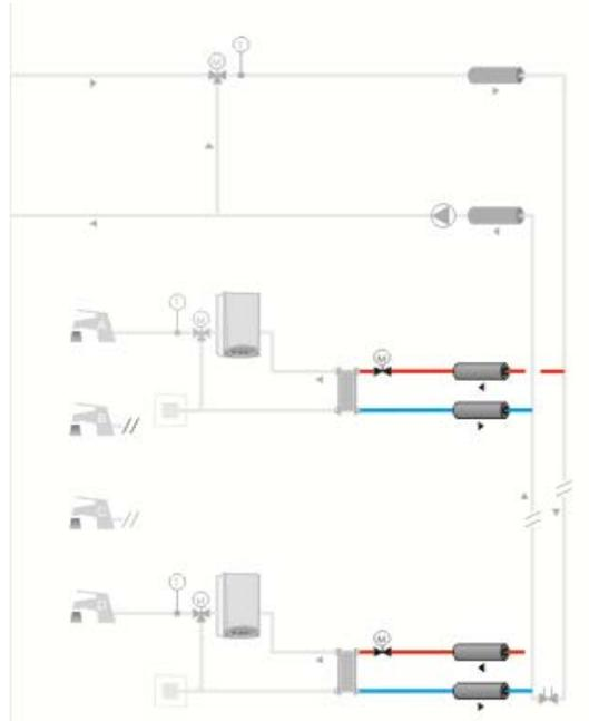
Para definir el circuito de distribución de las subestaciones es necesario especificar la longitud de las tuberías total (impulsión y retorno), desde el bajante (distribución vertical) hasta la subestación (vivienda, para el caso de una vivienda), el diámetro interior de la tubería (mm), el tipo de aislante y su espesor (mm).
