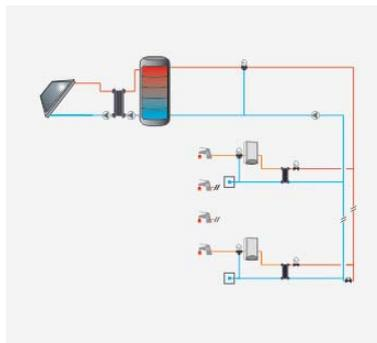
Sistema solar térmico para la producción de agua caliente sanitaria (ACS) en instalaciones de consumo múltiple con acumulación solar centralizada e intercambiador de calor externo, con intercambiadores de consumo distribuido, sistemas de apoyo instantáneos en serie y válvulas termostáticas.
