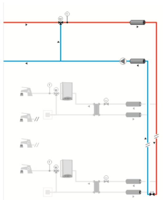
Para definir el circuito de distribución es necesario especificar la longitud total de las tuberías (impulsión y retorno o recirculación en su caso), el diámetro interior de la tubería (mm), el tipo de aislante y su espesor (mm).
