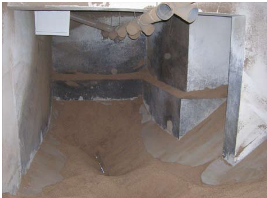
Figura 5.1: Silo de carbón reconvertido a silo de hueso de aceituna.
