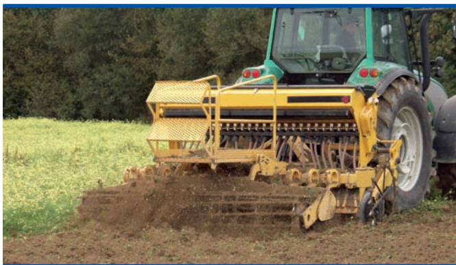
Tren de cultivo grada rotativa + sembradora + rulo.
