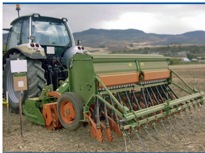
Tren de cultivo con grada rotativa + rulo packer y sembradora.
