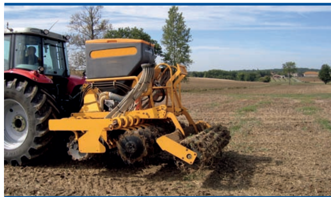
Tren de cultivo grada de discos + sembradora + rulo.
