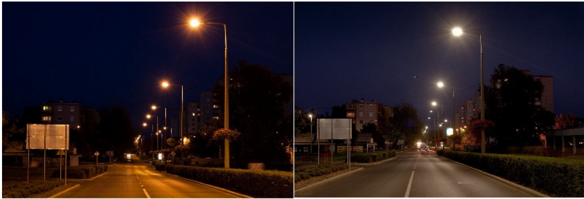
Figura 3: Kaszap Road, sustitución VSAP por LED (©Hódmezővásárhely, Tungsram-Schröder)
