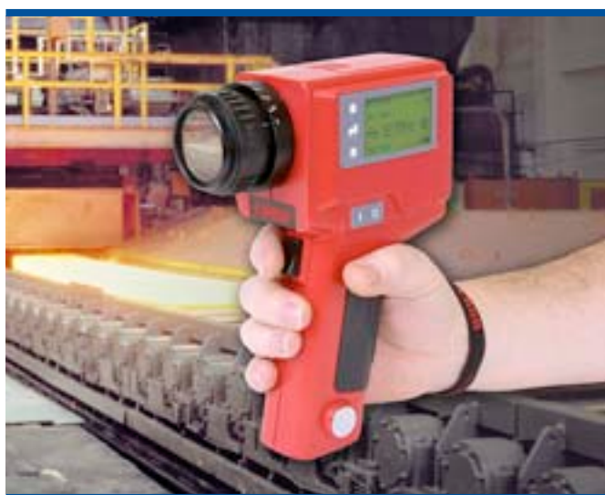
Figura 1.7. Termómetro de infrarrojos para la medida de la temperatura de los cuerpos sólidos (Fuente: LAND - www.landinst.com )
