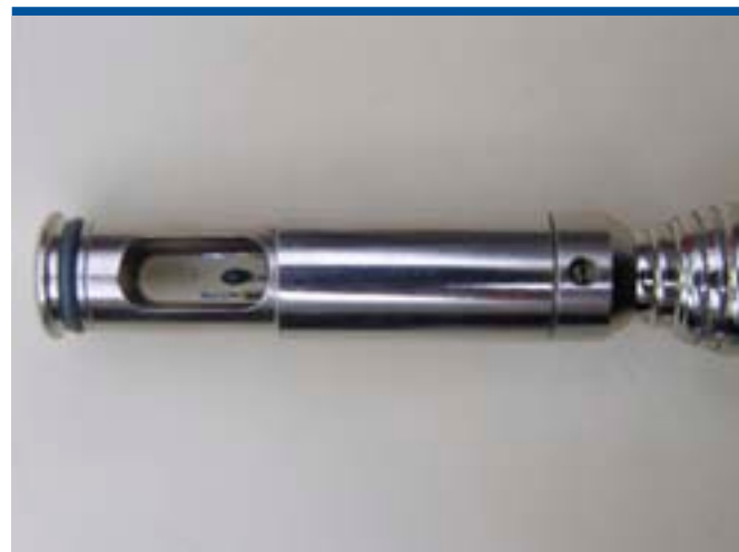
Figura 1.9. Detalle del elemento sensor de un anemómetro de hilo caliente para la medida de la velocidad del aire
