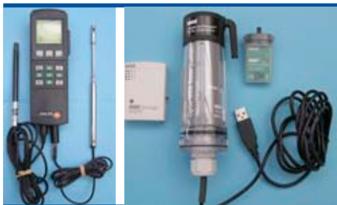
Figura 1.6. Sondas para la medida de la temperatura y la humedad relativa ambiente, formando parte de completos equipos supervisores (imagen de la izquierda, que incluye además un anemómetro) o de equipos registradores para realizar campañas de medida prolongadas (imagen de la derecha)
