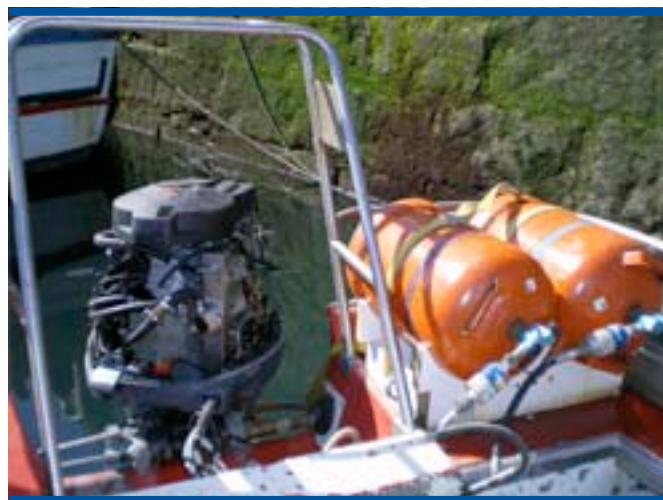
Fig. 9.13. Detalle de motor y bombonas de GLP en lancha fueraborda (Fuente y elaboración propias)
