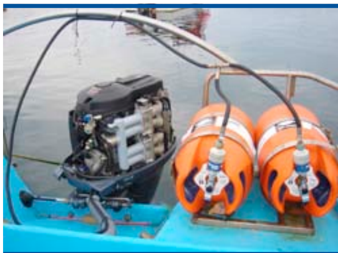
Fig. 8.1. Kit y bombonas embarcación con motor fueraborda (Fuente y elaboración propias)
