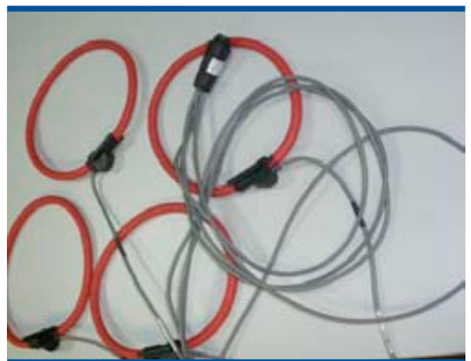
Fig. 4.6. Sensor eléctrico trifásico (detalle de los anillos amperimétricos) (Fuente y elaboración propias)
