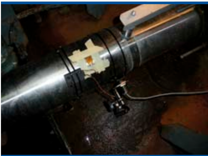
Fig. 4.8. Galgas y emisor de torsiómetro instalados en el eje (Fuente y elaboración propias)
