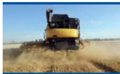
Foto 24. Cosechadora esparciendo restos de cosecha homogénea a todo el ancho de corte
