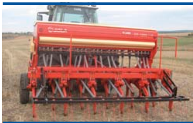
Foto 27. Detalle del tren de siembra de una sembradora directa de rejas
