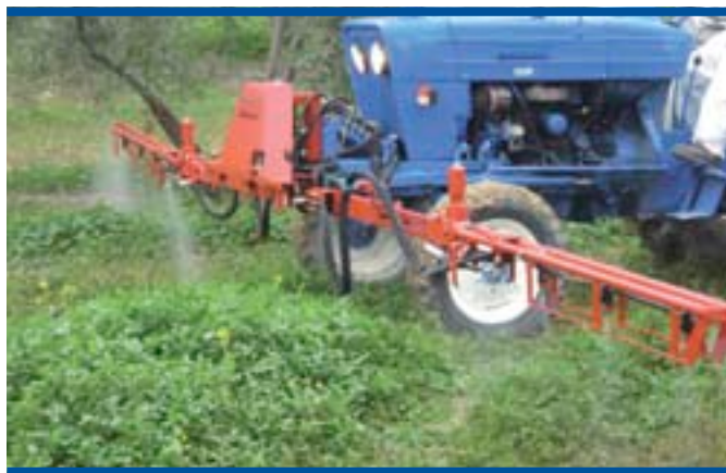
Foto 17. Barra totalmente paralela al terreno, realizando un correcto tratamiento a la cubierta
