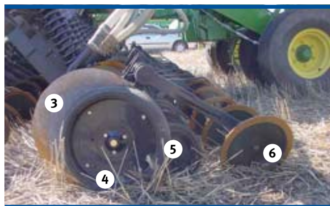
Foto 26. Detalle del tren de siembra de una sembradora directa de discos. (1. Disco de corte de restos vegetales, 2. Dispositivo barretrastos, 3. Disco de apertura de línea de siembra, 4. Sistema de control de profundidad, 5. Elemento fijador de semilla, 6. Elemento de cierre del surco)
