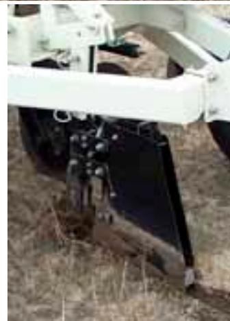
Figura 54. Equipo espectrofotométrico comercializado por la empresa VERIS, trabajando sobre rastrojo. Inferior: detalle de la reja por dentro de la cual viaja la señal óptica
