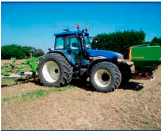
Figura 7. Tractor dotado con un sistema de posicionamiento GPS y equipado con una abonadora con control del caudal de fertilizante, preparado para la aplicación de mapas de fertilización
