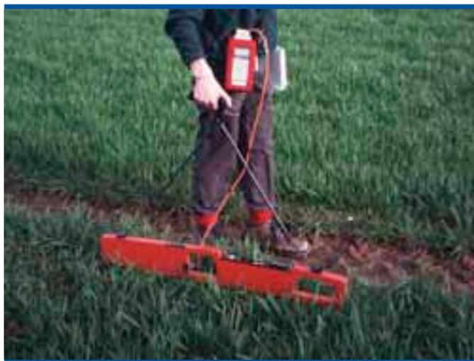
Figura 52. Equipo EM-38 de Geonics, para realización de mapas de inducción magnética
