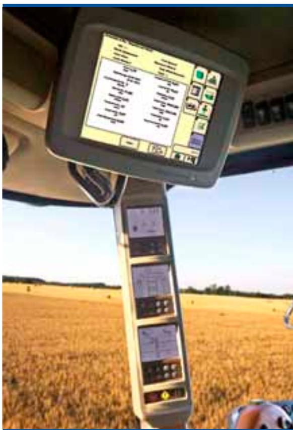
Figura 60. Los monitores con tecnología ISOBUS pueden ser empleados en cosechadora o tractor, y controlar varios aperos
