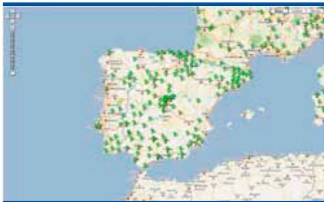
Figura 13. Estaciones base de la red SmartNet de Leica en España. (Fuente: Leica Spiderweb)
