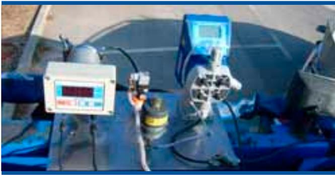
Figura 59. Sobre vendimiadoras es posible instalar sensores de calidad del mosto (°Brix) como los de la figura (Barreiro, 2009)
