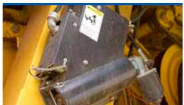
Figura 58. Sensor de humedad del grano situado en el elevador de grano limpio a la tolva
