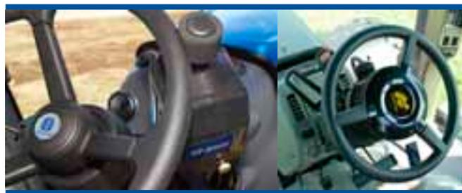
Figura 31. Izquierda: Sistema de autoguiado Ez Steer de Trimble. Derecha: Volante eléctrico AES-25 Electric Steering de la firma TOPCON
