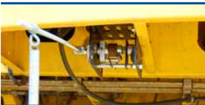
Figura 57. Sensor de actividad (altura) del cabezal situado bajo la cabina, sobre el canal de ascensión de mies
