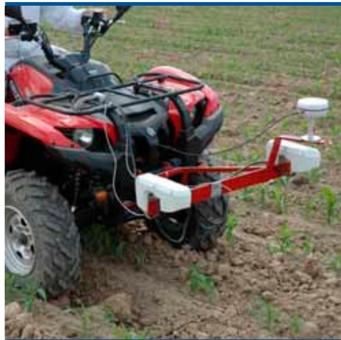
Figura 44. Sistema de mapeo basado en sensores optoelectrónicos (Andújar *et al.*, 2009)
