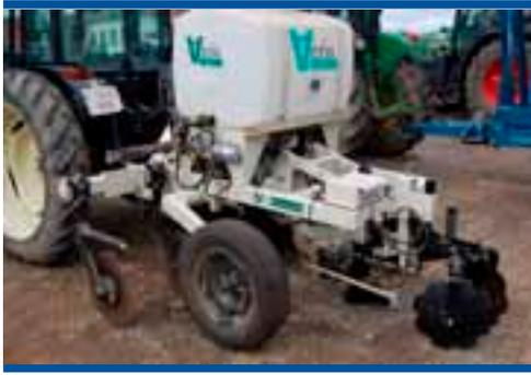
Figura 55. Plataforma móvil para el análisis directo de suelo mediante matrices de electrodos ISE
