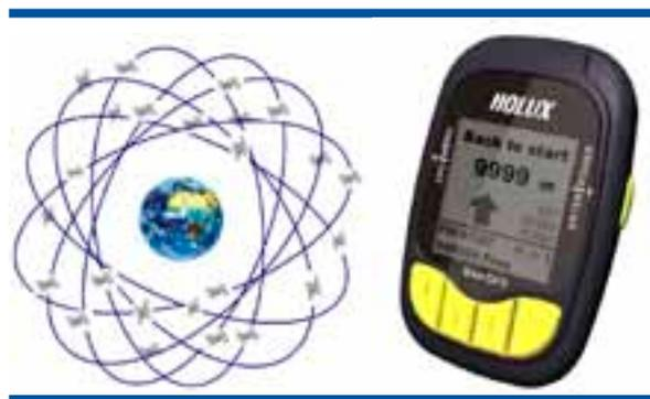
Figura 8. Izquierda: Constelación de los 24 satélites que giran alrededor de la tierra (Fuente: [www.garmin.com](http://www.garmin.com)). Derecha: Receptor GPS de mano con pantalla LCD para la presentación de datos (Fuente: [www.holux.com](http://www.holux.com))
