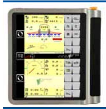
Figura 38. Terminal virtual ISOBUS de última generación, que incluye doble pantalla para poder mostrar los controles de dos implementos a la vez (sembradora y tractor, por ejemplo) (Kverneland)
