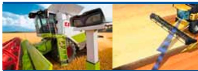
Figura 32. Izquierda: Fotografía del sensor Laser Pilot de Claas. Derecha: Imagen representativa de los datos capturados por el sistema Smart Steer de New Holland
