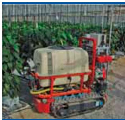
Figura 69. Motomáquina robotizada (“fitorobot”) para aplicación automática de productos fitosanitarios en invernaderos, de diseño andaluz y premiada en el certamen internacional UNACOMA Vision Event (cortesía de CADIA Ingeniería)
