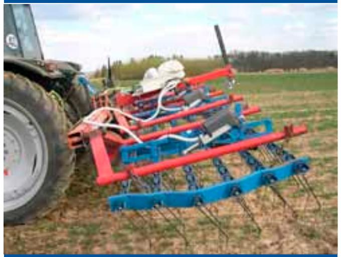
Figura 50. Grada canadiense con inclinación variable autónoma basada en la densidad de malas hierbas (Rueda & Gerhards, 2009)
