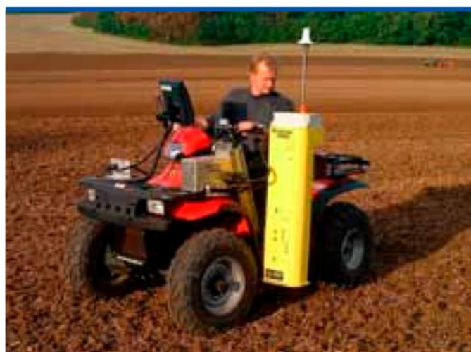
Figura 5. Equipo automático de toma de muestras georreferenciadas de suelo para su posterior análisis en laboratorio
