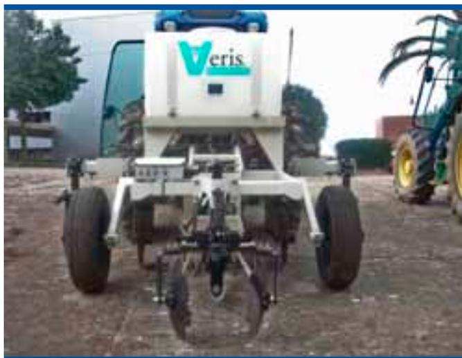
Figura 66. Sensor de conductividad eléctrica del suelo suspendido a los tres puntos del tractor
