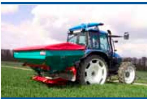
Figura 56. Sensor espectrofotométrico de vigor vegetativo colocado sobre el tractor para aplicación variable de nitrógeno en tiempo real (N-sensor, Yara)
