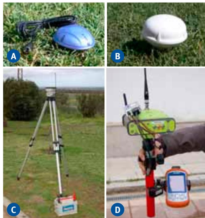
Figura 9. Receptores GPS de cable con diferentes niveles de calidad. A: Receptor Haicom 204III que posiciona con errores RMS de 10 metros. B: Equipo receptor GPS de Novatel con recisiones submétricas. C: Estación base RTK GPS que ofrece correcciones de precisión centimétrica. D: receptor RTK capaz de conectarse a redes GNSS (RTK) mediante enlaces de radio, GPRS y el estándar RTCM
