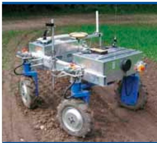
Figura 71. Equipo robotizado para la aplicación selectiva de herbicidas (Fuente: Universidad de Copenhague: Center for Precision Farming)
