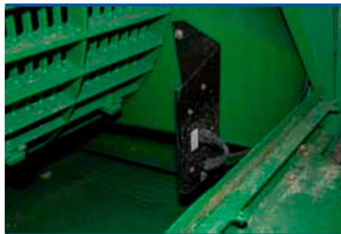
**Figura 64. Sensores de pérdidas de grano de una cosechadora con cilindro trillador axial (John Deere STS)**
