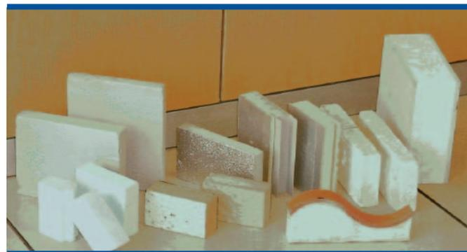
Los materiales de construcción aislantes son productos empleados en la edificación, fabricados con materiales de un alto nivel aislante: bloques de arlita, bloques de hormigón celular, etc., o productos obtenidos a partir de procesos de fabricación que les confieren un gran poder aislante, por ejemplo, los bloques “termoarcilla”.
