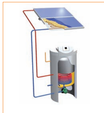
Ejemplo de equipo tipo "drain back"
