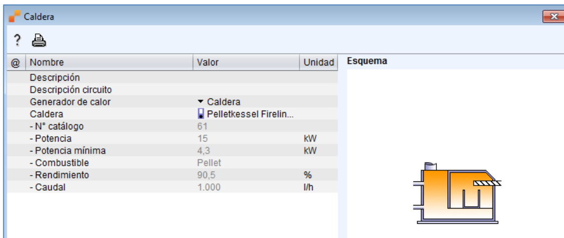
Figura 110: Parámetros que definen las calderas. (Fuente: POLYSUN)
