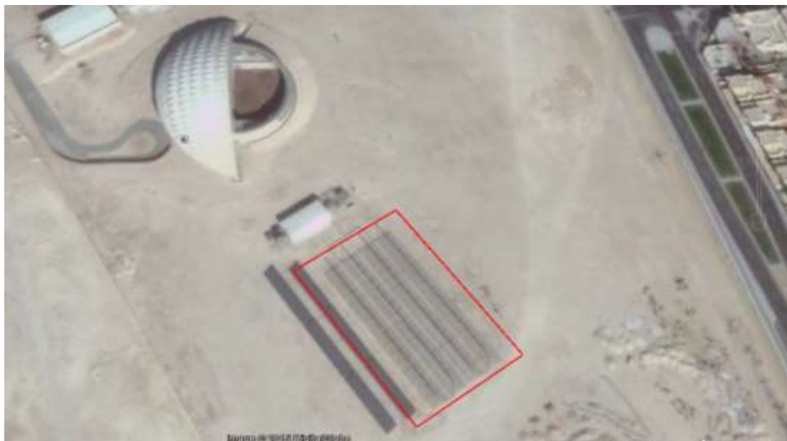
Figura 82: Fotografía de la instalación Fresnel de Qatar. Superficie limitada por la línea roja ~ 3.500 m 2 (Fuente: Google Earth)
