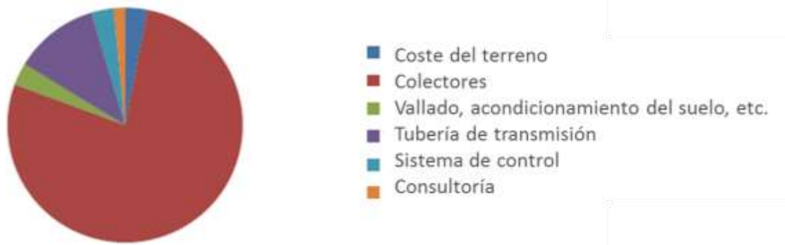
Figura 130: Distribución de costes de una instalación solar (excluyendo tanque de acumulación). (Fuente: Solar district heating guidelines - PlanEnergi)
