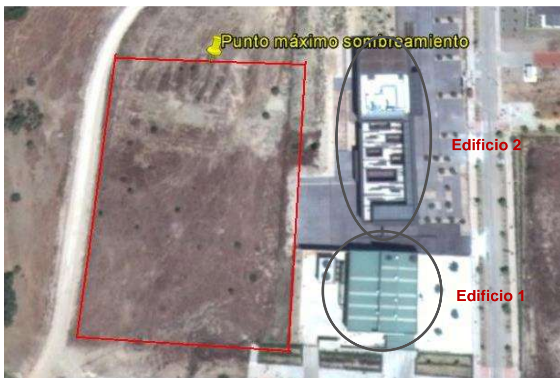
Figura 79: Edificios que generan sombras en la parcela estimada para los captadores y ubicación del punto de máximo sombreadamiento. (Fuente: Google Earth)
