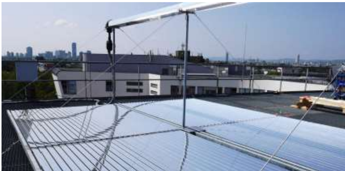
Figura 38: Sistema lineal Fresnel. Panel CSP (Concentrated Solar Power) de Fresnex. (Fuente: Fresnex GmbH)
