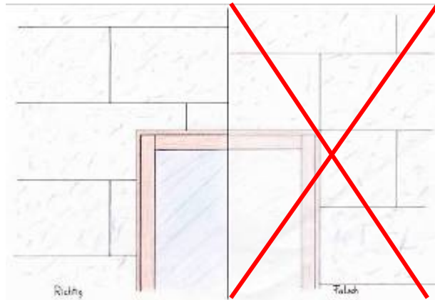
Figura 19. Detalle de la instalación de las planchas de aislamiento en los cantos de esquinas de un hueco
