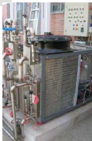
Prototipo máquina de absorción simple-doble efecto - CSIC
