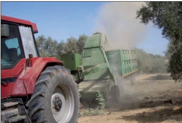
Cabezal prototipo de astillado propulsada por tractor.
