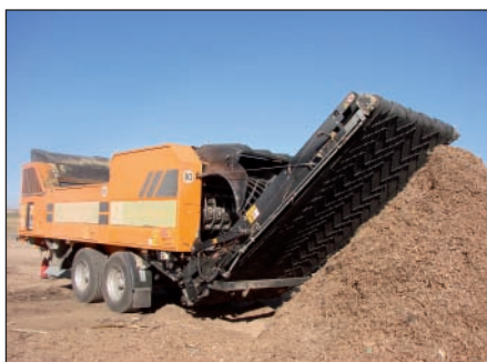
Trituradora trabajando con sarmientos. Fuente: Elaboración propia y Factor Verde.
