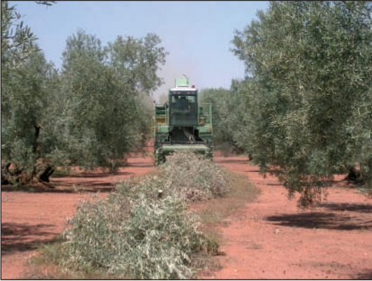
Astilladora autopropulsada Sat3 trabajando con poda de olivo.
