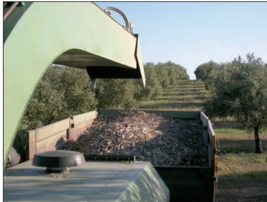
Astilladora autopropulsada Sat3 trabajando con poda de olivo.
