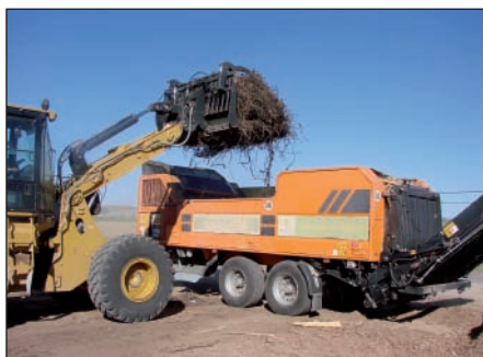
Trituradora trabajando con sarmientos. Fuente: Elaboración propia y Factor Verde.
