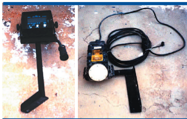
Figuras 2A y 2B: Controlador de prestaciones Dickey-john CMS 100 para tractores: Consola. Radar
