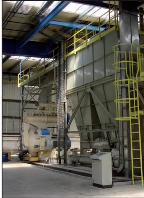
Equipos de enfriamiento y filtrado de aire y peletizadora de Ebepellet, Muxika (Vizcaya).
