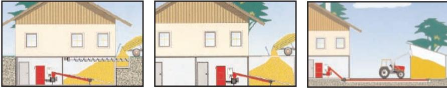
De izquierda a derecha: sistema de almacenamiento dentro del edificio, fuera del edificio y cercano al edificio.
