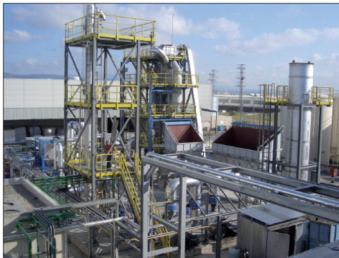
Scrubber de biodiésel. Fuente: GUASCOR.
