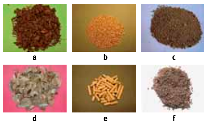
Figura 9. Ejemplos de combustibles comercializados para aplicaciones de generación de calor: a) orujo de uva seco, b) hueso de aceituna, c) cáscara de almendra, d) astillas de madera, e) pellet de madera y f) orujillo de aceituna (CGC Biomasa)
